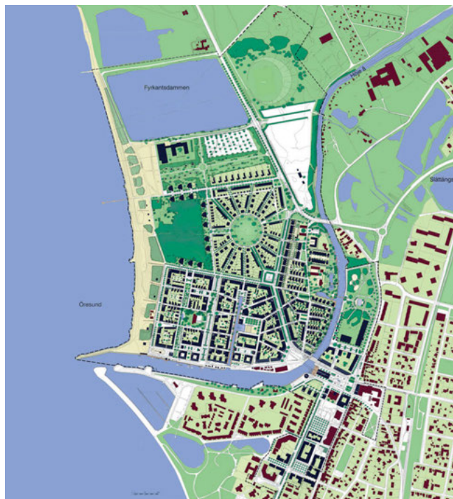
FIGUR 5. Fördjupning av översiktsplan visar huvuddragen i planerad bebyggelseutveckling som underlag för kommande detaljplanering. I Lomma skedde denna planering på områdesnivå i form av ett planprogram, upprättat 2003. Kartan tillhör Lomma kommun.
