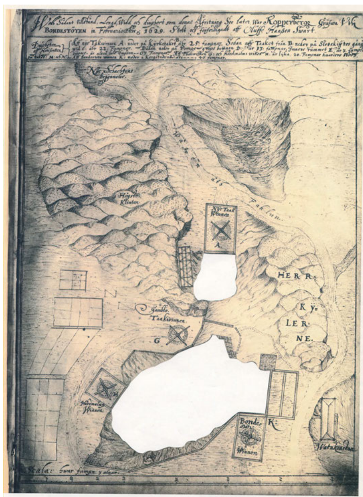
FIGUR 6. Kopparbergz Grufwa Uthi Bondestöten in Februari Åhr 1629. Stelt och förferdigadt aff Oluff Hansson Swart. Bergslagens arkiv, Falun. Swart (senare adlad Örnebuvud) har här återgett dagbladet till Bondestöten i Stora Kopparbergs gruva. Vid A öppning till Pumpegropen, stora hålet visar den vidlyftiga Bondestöten öppen ner till 46 famnars djup; t.h. Bondestötskonsten. Längst upp t.v. plats för gruvans första schakt.
