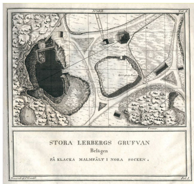
FIGUR 7. Lerbergs gruva uppmätt av markscheidern Gustaf Bergström. Kopparstick av J. Grandel i L. Horneman, Försök til handledning uti svenska markscheideriet . Stockholm 1802. Dagblad jämte två nivåblad mätta enligt den svenska metoden samt profilritning enligt tysk metod. På dagbladet anger linjen A-B gruvans skärningsyta så som den återges på profilritningen. Markscheidern har haft oo på kullen i bildens mitt som avvägningspunkt till sina mätningar.
